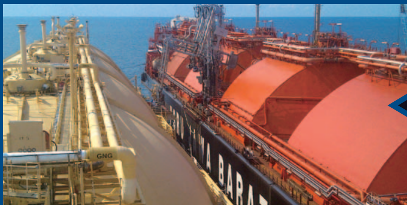
The LNG carrier LNG AQUARIUS (left) offloading to an FSRU (Jakarta, Indonesia)
