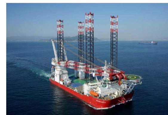
洋上風力発電設備設置船
