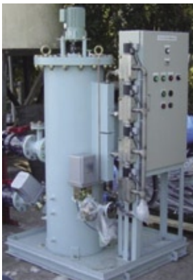
バラスト水処理装置
