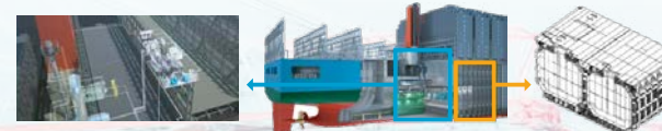
LNG燃料化の配置イメージ図 LNG燃料対応関連機器配置 LNG燃料タンク搭載
