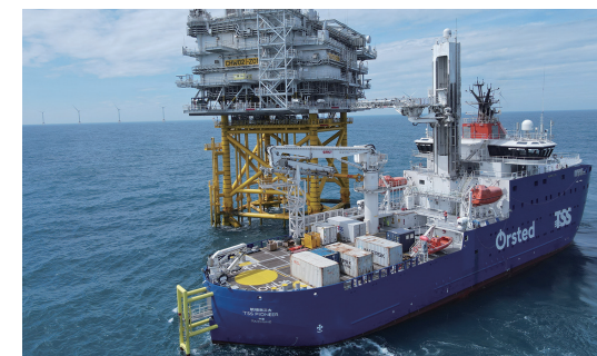
洋上変電所にメンテナンス技師を輸送中のSOV
