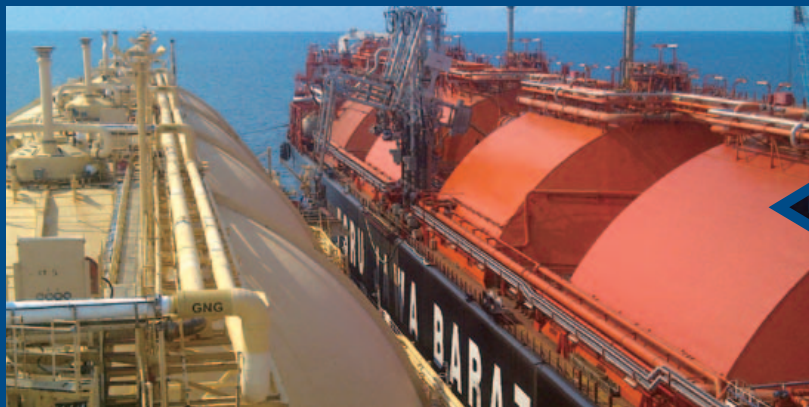
LNG船「LNG AQUARIUS (左)」からFSRUへの揚荷役 (ジャカルタ、インドネシア)
