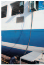
陸上電力受電システム
