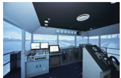
全方位視野に対応した高機能操船シミュレーター
