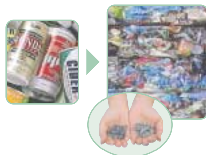
「トライアール神戸」による空き缶リサイクル(空き缶からスチールとアルミのペレットへ)
