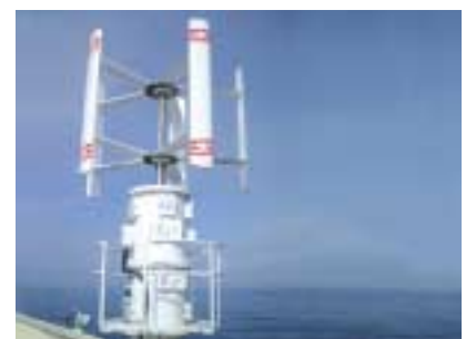
実証実験船TAIHO MARUに取り付けられた風車 写真2
