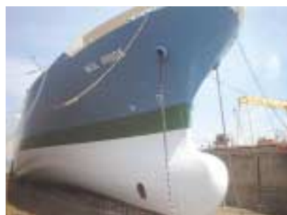
シリコン樹脂塗料を塗布したコンテナ船
