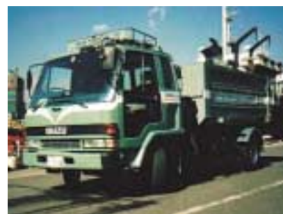
アーバンサービスが所有するコンテナ水洗、温水洗、科学洗浄する車
