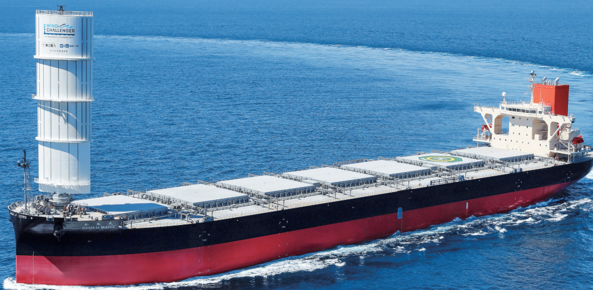
世界初のウインドチャレンジャー（硬翼帆式風力推進装置）搭載ばら積み船「松風丸」
