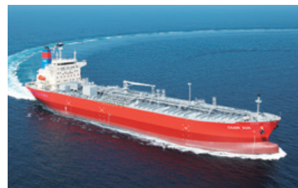
Net Zero Voyageを実施したメタノール二元燃料船「CAJUN SUN」
