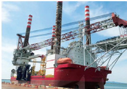
洋上風力発電設備設置船「SEAJACKS ZARATAN」
