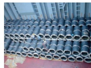
ワイヤーロッドの積み付け
